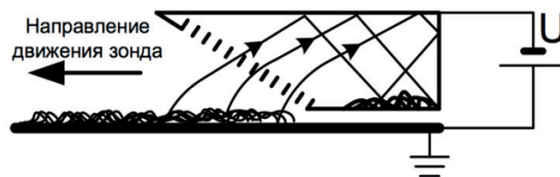
Рис. 4. Схема работы электростатического зонда
