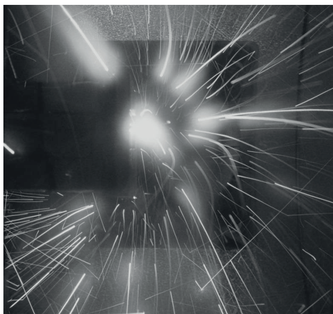
Рис. 2. Треки капель, инжектируемых с вольфрамовой мишени. Поток водородной плазмы падает на мишень справа
